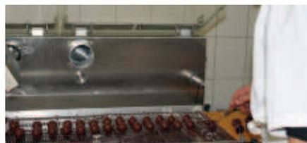
Stephan Raab arbeitet mit einer LCM 320 ATC, an die sich ganz einfach ein Kühltunnel anschließen lässt. Die Überzug- und Temperiermaschine lässt sich einfach bedienen und reinigen sowie schnell umrüsten. Der Kühltunnel bietet durch seine Breite und Höhe auch Platz für Torten und Kuchen.
